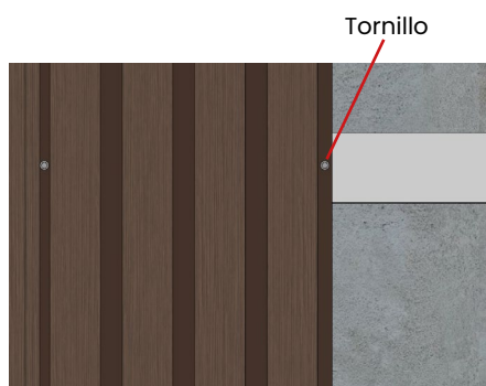
4. Fija el primer panel de WPC en la estructura de soporte
